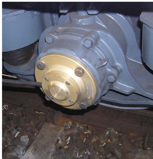
Czujnik ATM-CO1 na maźnicy wózka pojazdu 14WE prod. NEWAG
